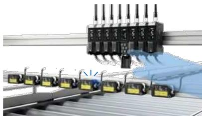
設定モードに切り替えると、接続中のセンサヘッドの表示灯が青色点滅。配線をたどる手間が不要。
